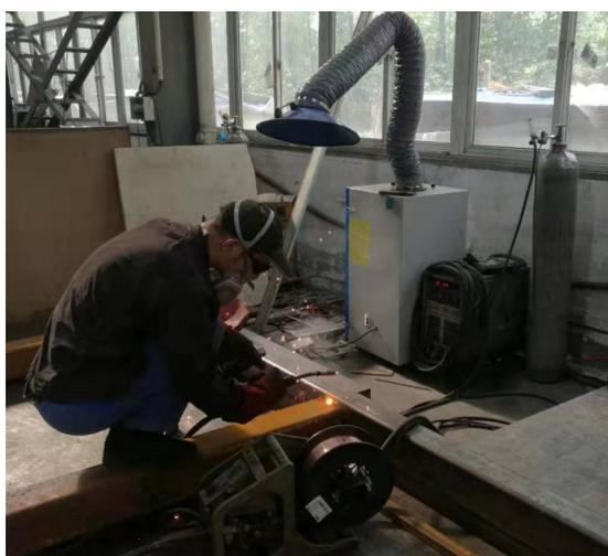
移动式焊接烟尘净化器
